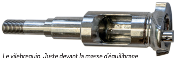
Le vilebrequin. Juste devant la masse d'équilibrage et le maneton, apparaît la gorge fraisée qui sert de chemin de roulement pour les billes du roulement arrière.
